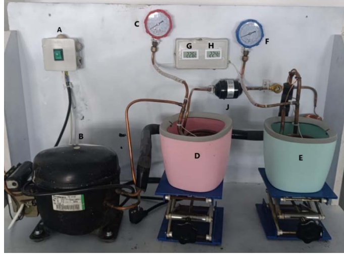
Şekil 2. Deney düzenegi (A: açma-kapama düğmesi, B: Kompresör, C: Yoğunlaştırıcı üstü basınç göstergesi, D: Yoğunlaştırıcı, E: Buharlaştırıcı, F: Kompresör girişi basınç göstergesi, G: Isınan suyun sıcaklığı, H: Soğuyan suyun sıcaklığı, J: Gaz Filtresi)
